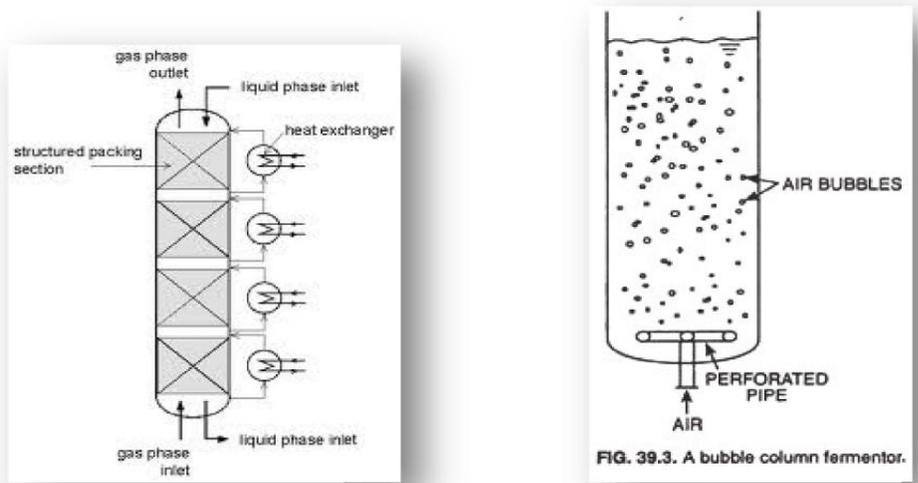
FIG. 39.3. A bubble column fermentor.
